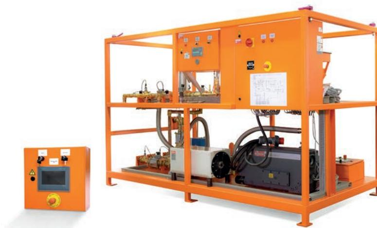
Установка высокой производительности с 10 портами для проведения операций по откачиванию воздуха, заполнению и откачиванию SF<sub>6</sub>
