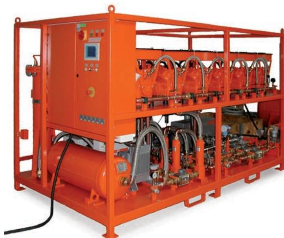
Установка обработки элегаза для электронных ускорителей
