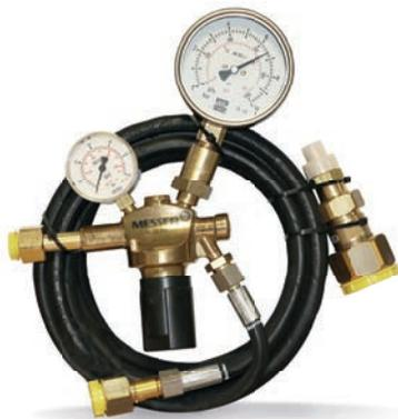
Ручные устройства позволяют заполнять электротехническое оборудование элегазом непосредственно из баллонов под давлением. Первичный датчик на редукторе отображает давление в баллоне в бар, кПа, пси. Вторичный датчик отображает желаемое давление заполнения и может быть легко отрегулировано с помощью рукоятки. Давление в баллоне может быть снижено использованием встроенного редуктора давления.
