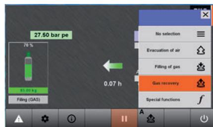
Программное обеспечение с графическим интерфейсом, делает управление легким и удобным.
