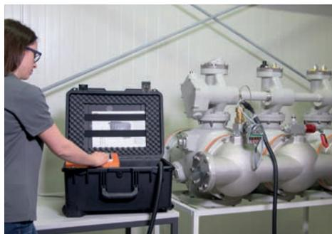
В сочетании со специальным запорным клапаном устройство контроля плотности DensiControl IN позволяет надежно проверять мониторы плотности непосредственно на газовом отсеке.
