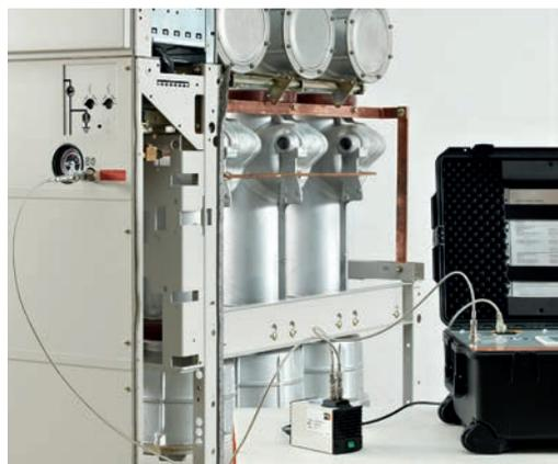
Мембранный компрессор установлен между выключателем среднего напряжения и измерительным прибором с помощью соответствующего соединительного шланга.
