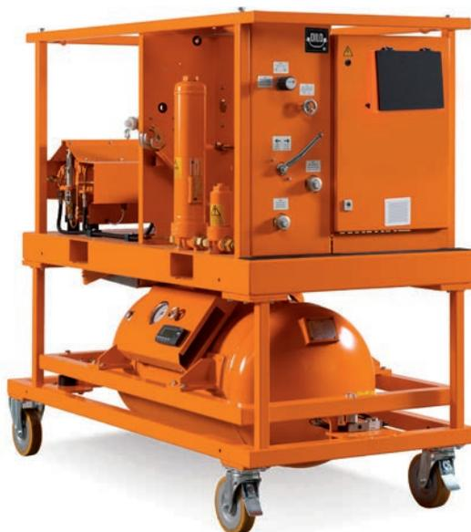
При использовании устройства типа B057R17 элегаз не выходит из резервуара в жидкой форме!
