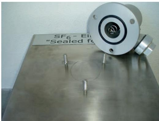
Фиксирование сварной шпильки перед монтажом на поверхности.
