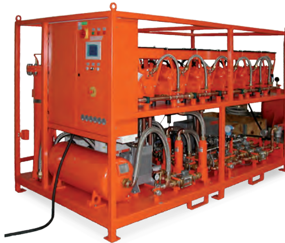
Installation de traitement du gaz SF 6 pour un accélérateur d'électrons.
