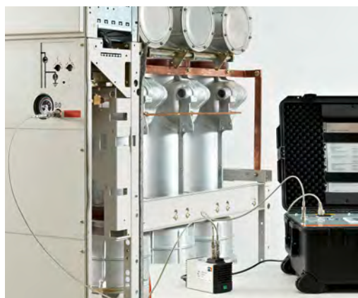
Le compresseur à membrane est raccordé entre le disjoncteur moyenne tension et l'appareil de mesure à l'aide du flexible de raccordement correspondant.
