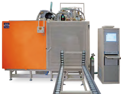
Exemple Série « LeakScanner SV » avec manquement du gaz intégré
