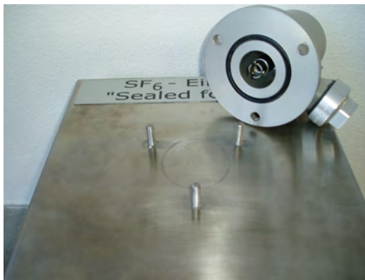
Fixation des boulons de soudage sur la surface avant le montage
