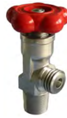
Soupape pour gaz SF 6 usagé avec un teneur de SO 2 ≥ 250 ppm v selon DIN 477 no. 8 - 1" acier inoxydable
