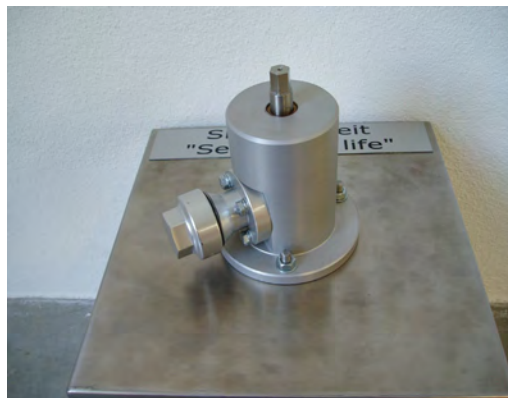
Dispositif de récupération monté sur la surface - prêt à être foré
