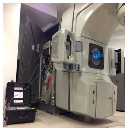
L'unité d'entretien B160R92 est adaptée aux exigences de petits compartiments de gaz. Photo: Appareil pendant des travaux de service d'une unité irradiante.
