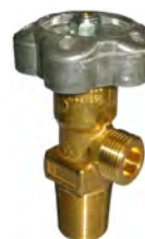
Soupape pour gaz SF 6 neuf*, gaz SF 6 reconditionné ainsi que gaz SF 6 usagé avec un teneur de SO 2 < 250 ppm v selon DIN 477 no. 6 W21,8 x 1/14" laiton
