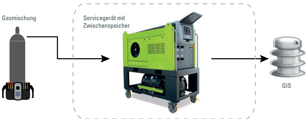
Abbildung 3: Darstellung der Funktionsweise eines Servicegerätes mit integriertem Zwischenspeicher zur Entnahme von teilverflüssigten Mischungen aus einem beheizten Druckbehälter.
